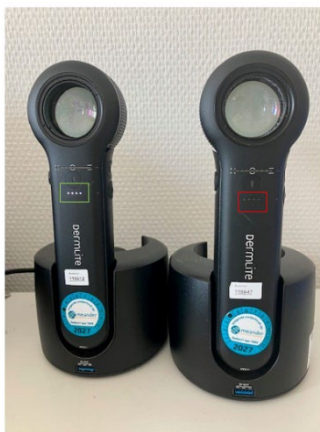
Links geheel opgeladen (4 lampjes brandend) Rechts batterij leeg (geen lampjes brandend)
